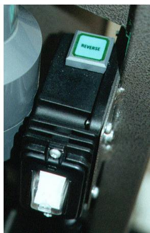
4. Maschine einschalten (Netzschalter).
