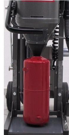
**7.** Reversierer zum Verfüllen und zum Reinigen der Filter mehrmals im 3-Sekunden-Takt betätigen. Überwachung des Abfüllprozesses am Sichtfenster.
