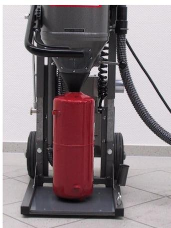
5. a) Verschießhebel nach unten drücken (Direktverfüllen).
