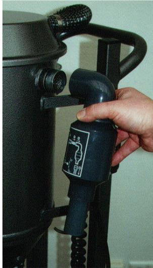
1. Rückschlagventil abziehen und Dichtung überprüfen.
