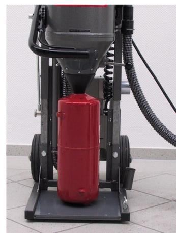
3. Pulverbehälter auf den Löscher aufsetzen und einrasten.
