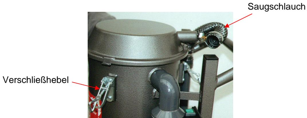
1. Verschlüsse öffnen und Saugschlauch abziehen.
