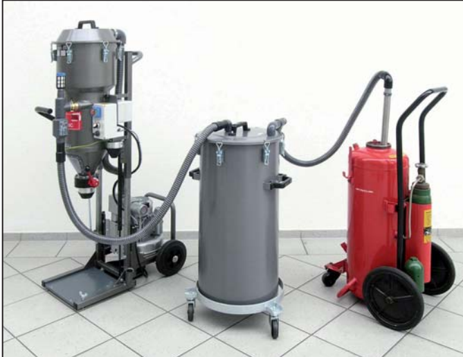
Bild 3: Bei Servicearbeiten an 50-kg-Feuerlöschern wird das Löschpulver mit der PSM ECONOMIC aus dem fahrbaren Feuerlöscher zunächst in den separaten Zusatzbehälter gesaugt.
