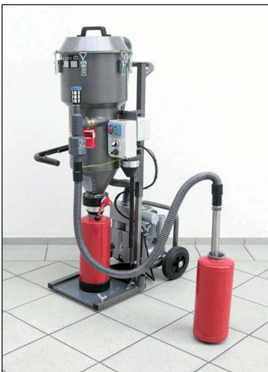
Bild 2: Müssen mehrere Feuerlöscher des gleichen Typs gewartet werden, können zwei Feuerlöscher gleichzeitig bearbeitet werden. Während ein Feuerlöscherbehälter mit dem Saugrohr entleert wird, kann gleichzeitig ein zweiter mit dem gereinigten Löschpulver unter dem Vorratsbehälter gefüllt werden.
