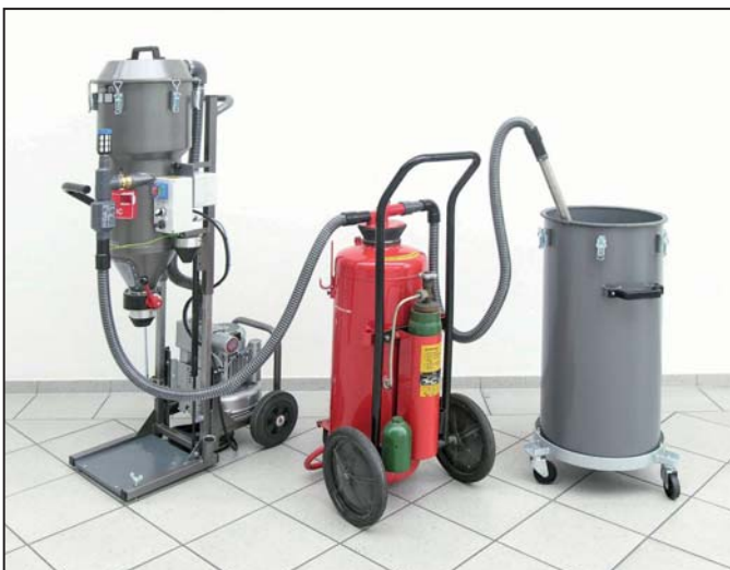
Bild 4: Nach der Prüfung des Feuerlöscherbehälters wird das Set SK 50 aufgesetzt und der Feuerlöscher wieder gefüllt.
