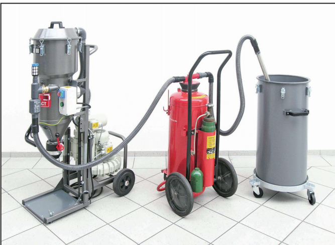
Bild 4: Nach der Prüfung des Feuerlöscher-Behälters wird das Set SK 50 aufgesetzt und der Feuerlöscher wieder gefüllt.
