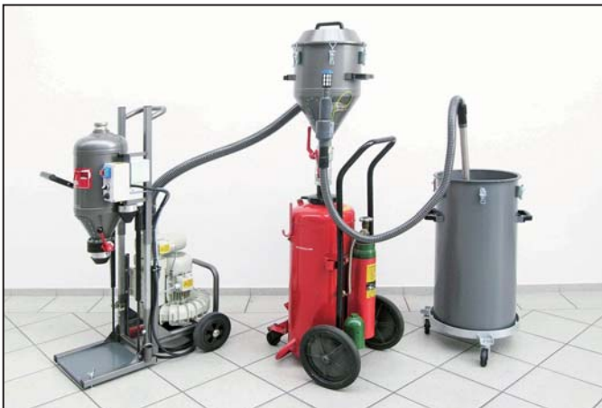
Bild 4: Mit einem Adapter kann der Filterkopf auf fahrbare Feuerlöscher direkt aufgesetzt und diese dann aus dem 50- oder 250-kg-Zusatzbehälter oder einem separaten Pulvergebilde gefüllt werden.
