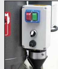
Bild 7: Zeitsteuerung für automatisches Abfüllen und für Reinigung der Filter Art.-Nr. 186038
