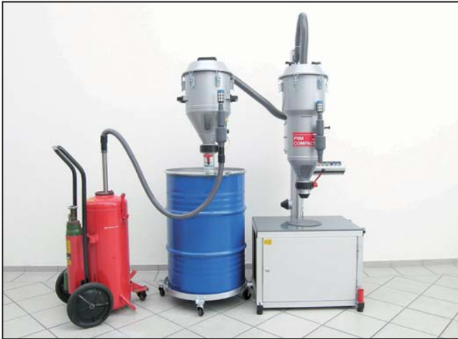
Bild 4: Die Maschine hat einen Vorratsbehälter mit einem Fassungsvermögen von 12 kg. Mit einem zusätzlichen Filterkopf (Bild 6) können mit der PSM COMPACT S auch fahrbare Feuerlöcher gewartet, gefüllt oder unbrauchbar gewordenes Löschpulver aus allen Feuerlöschern entsorgt werden. Das Bild zeigt das Entleeren eines 50-kg-Feuerlöschers in eine Tonne für 250 kg Löschpulver.
