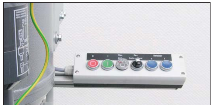
Bild 2: Die serienmäßige Zeitsteuerung des Reversiervorgangs dient der schnellen automatischen Abfüllung und der Reinigung der Filter.
