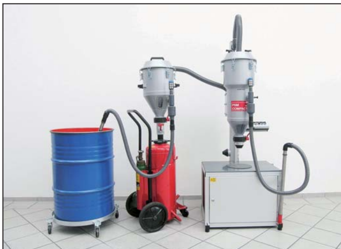
Bild 5: Nach der Prüfung des fahrbaren Feuerlöschers wird der Filterkopf (Bild 6) umgesetzt und der Feuerlöscher aus der Tonne oder dem Zusatzbehälter (Bild 9) wieder befüllt.
