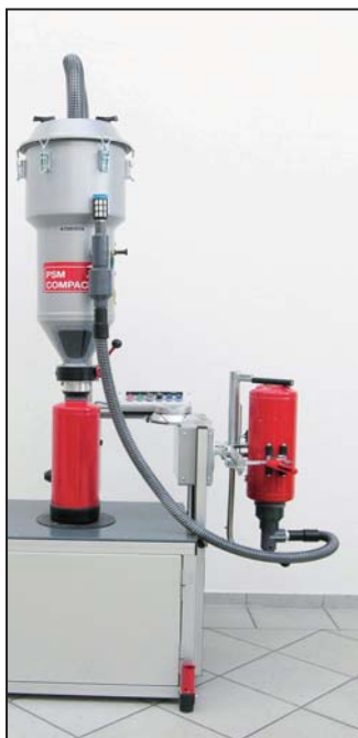
Bild 3: Mit dem angebauten (als Zubehör erhältlichen) Feuerlöscher-Entleerungs-System FES können die Feuerlöcher wesentlich schneller und bequemer gewartet werden.
