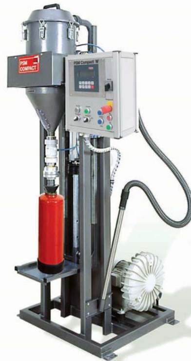
Bild 2: Die PSM COMPACT W ist eine stationäre Füllanlage für Prüfdienstwerkstätten und für große Stückzahlen. Sie ist mit einer elektronischen Waage ausgestattet, die nach Erreichen der Löschpulver-Füllmenge automatisch abschaltet.
