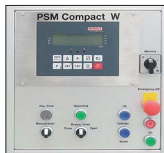
Bild 3: Bedientableau mit allen Bedienelementen und integrierter Waagenanzeige.
