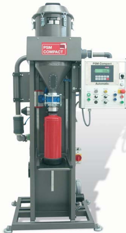
Bild 4: Die PSM COMPACT A ist eine Löschpulver-Füllanlage für Serienarbeiten in der Produktion. In diesem Anwendungssegment stellt sie eine äußerst kostengünstige und wirtschaftliche Lösung dar. Während des automatischen Füllvorgangs können andere Arbeiten, wie z. B. Vorbereitungen für den nächsten Füllvorgang oder das Verschließen der gefüllten Feuerlöcher erledigt werden.
