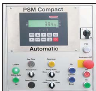
Bild 5: Bedientableau mit allen Bedienelementen und integrierter Waagenanzeige.
