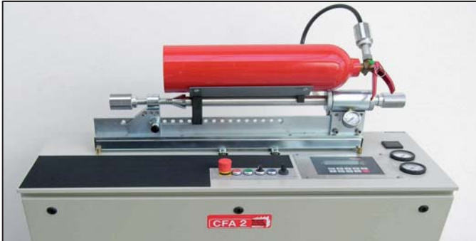
Bild 5: Füllkopf F3 für 2- bis 6-kg-CO 2 -Feuerlöscher Art.-Nr. 186104
