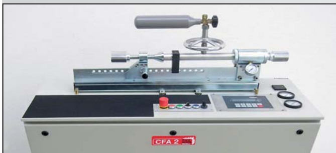
Bild 4: Füllkopf F2 für außenliegende CO 2 -Flaschen mit Drehventil bis ca. 300 g Art.-Nr. 186103
