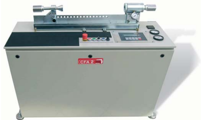
Bild 1: Die CFA 2 ist eine Kohlensäure-Füllanlage mit regelbarer Füllleistung und drehzahlgesteuertem Motor. Der Universalfüllkopf F1M ist auf einer elektronischen Wägezelle montiert. Das Bedientableau ist ergonomisch günstig angeordnet.
