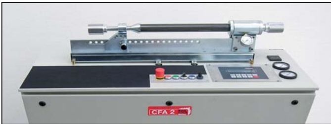
Bild 3: Der Füllkopf F1M für innenliegende CO 2 -Patronen mit Universal-Vorsatzflansch und der CO 2 -Anschlussschlauch zur Versorgung der Anlage sind im Lieferprogramm enthalten.
